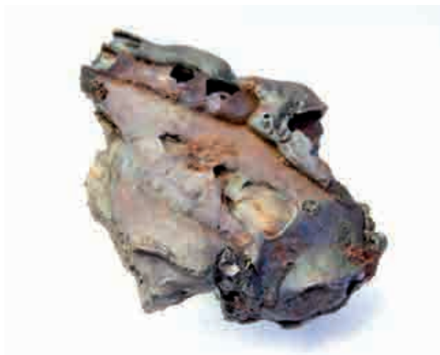
Fig. 19. Fragmento de escoura de sangrado (sen escala)
